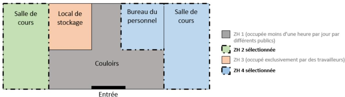
Dans cet exemple, la zone homogène n° 4 a déjà été définie lors de l'étape précédente de détermination des zones homogènes. A l'étape de sélection, elle n'est pas « amputée » du bureau du personnel. Pour la pose des détecteurs, on sélectionne la pièce occupée par les élèves, c'est-à-dire la salle de cours.
